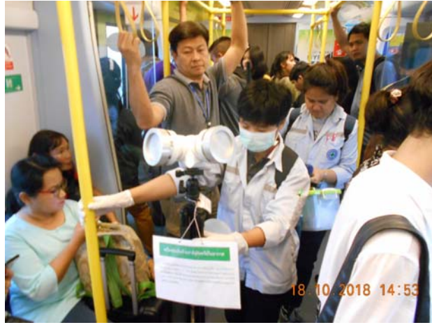
การตรวจวัดคุณภาพอากาศภายในขบวนรถไฟฟ้า
