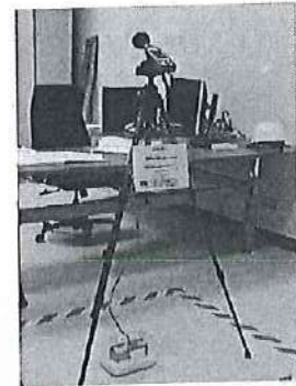
รูปที่ 2-3 แสดงการติดตั้งเครื่องตรวจวัดระดับเสียงในสถานประกอบการ
